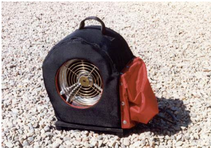
Moteur et sa couverture avec la mousse. Connecteur par velcro.
